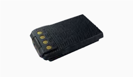
对讲机方形锂电池组 组装方式: 2S1P 充电温度: 0°C~+45°C 标称容量: 1515mAh 放电温度: -20°C~+60°C 应用领域: 对讲机终端
