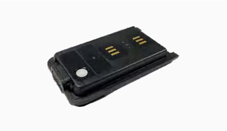
对讲机方形锂电池组 组装方式: 2S1P 充电温度: 0°C~+55°C 标称容量: 2200mAh 放电温度: -20°C~+60°C 应用领域: 对讲机终端 防尘防水等级: IP67
