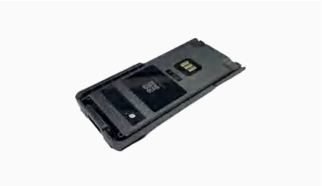
对讲机方形锂电池组 组装方式: 2S1P 充电温度: 0°C~+55°C 标称容量: 2450mAh 放电温度: -20°C~+60°C 应用领域: 对讲机终端 防尘防水等级: IP68
