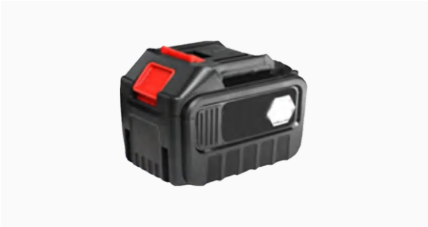
电动工具电池组 应用于: 电钻、电动螺丝刀、冲击钻、电动扳手、电锯等 电 芯 品 牌: Panasonic/国产电芯 电 芯 类 型: 18650 电 压: 3.6V~48V (1串/~13串) 容 量: 容量依客户需求设计 尺 寸: 根据产品定制 充 电 温 度: 0°C~+45°C 放 电 温 度: -20°C~+60°C 优 势: 配套开发/电流可选/通信/高精度芯片/精确数据传输/温度控制
