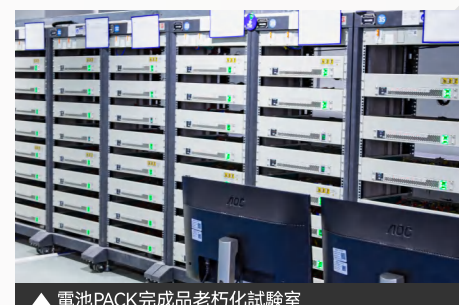
▲ 電池PACK完成品老朽化試験室
