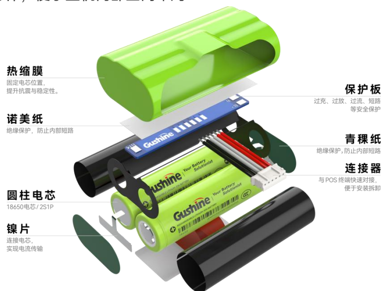
GS-XA014B POS电池案例 结构拆解
